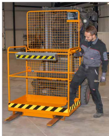
Einstieg durch Heben der Sicherungsstange
