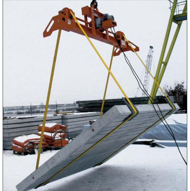
422572: **WTV 4,5/2**, Tragfähigkeit 4,5 t, Arbeitsbreite manuell verstellbar von 1,0 bis 2,0 m
