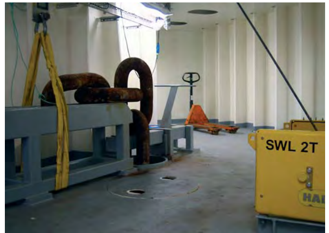
Elektro-Seilwinde Figur 42/87 E Zugfähigkeit: 2 T eingesetzt für Servicearbeiten an den Verankerungsketten der Plattform
