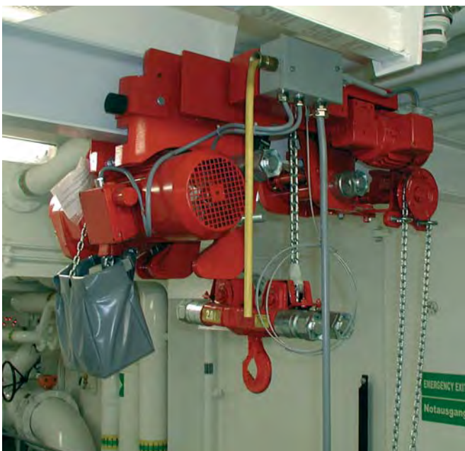
Elektro-Kettenzug Figur 29/94 EH extrem kurze Bauart mit Haspelfahrwerk Tragfähigkeit: 2 T
