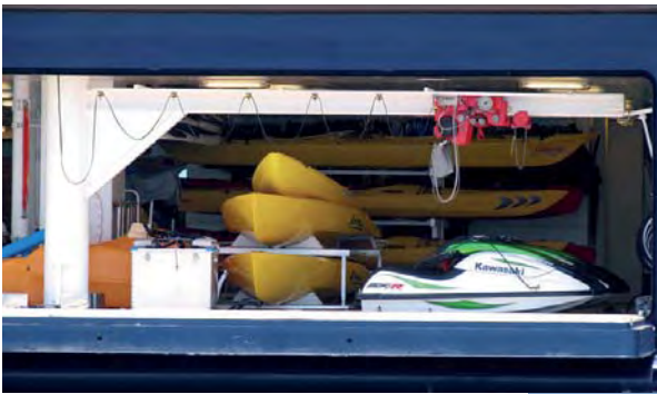
Säulenschwenkkran mit Elektro-Kettenzug extrem kurze Bauart und Feststellvorrichtung
