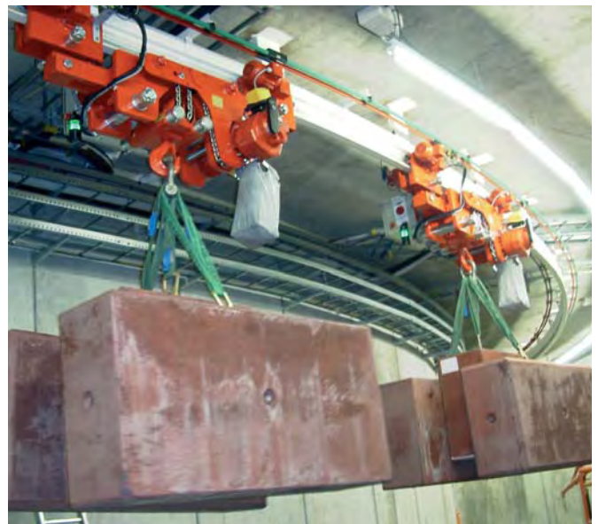
Elektro-Kettenzug Figur 29/94 EE extreme kurze Bauart mit Drehschemel-Elektrofahwerk Tragfähigkeit: 5 T
