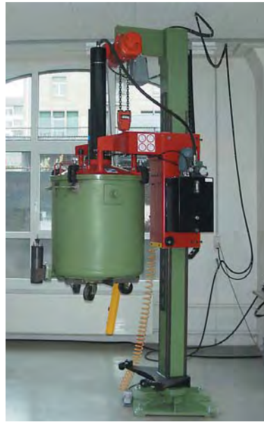
Elektro-Kettenzug Figur 66/04 AKS stationär eingesetzt in der Lebensmittelindustrie
