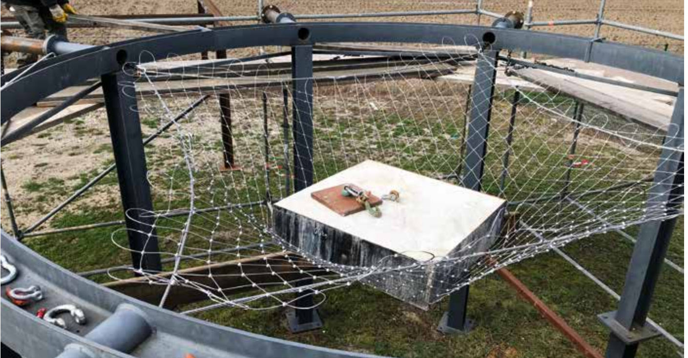
Drahtseilnetz DRALO "XTReme" im Versuchs-Rahmen
