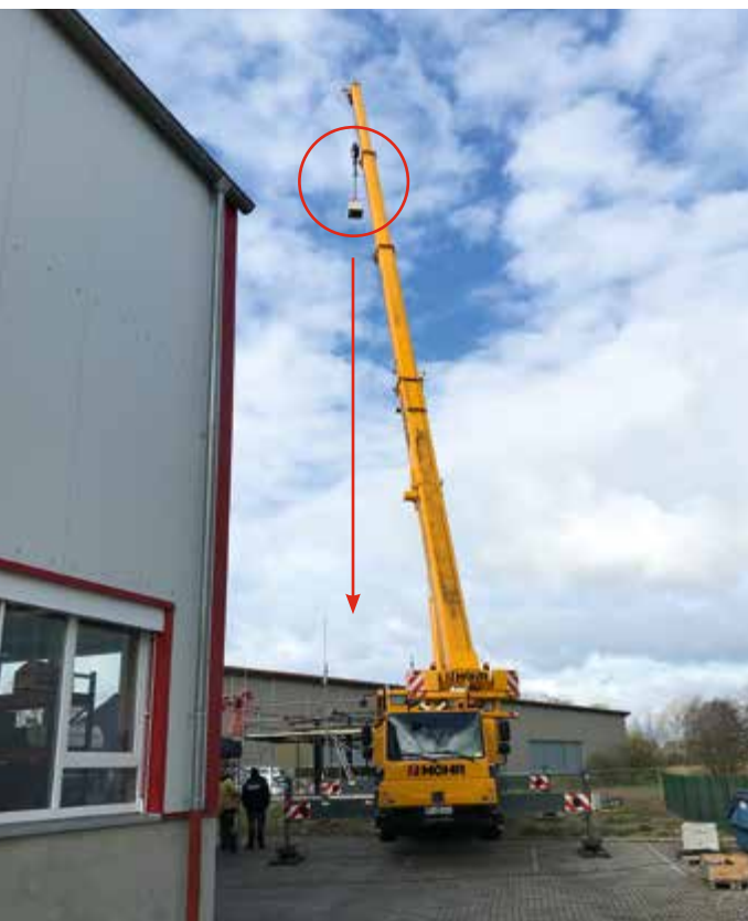
Fall-Versuch aus 22,50 m Höhe
