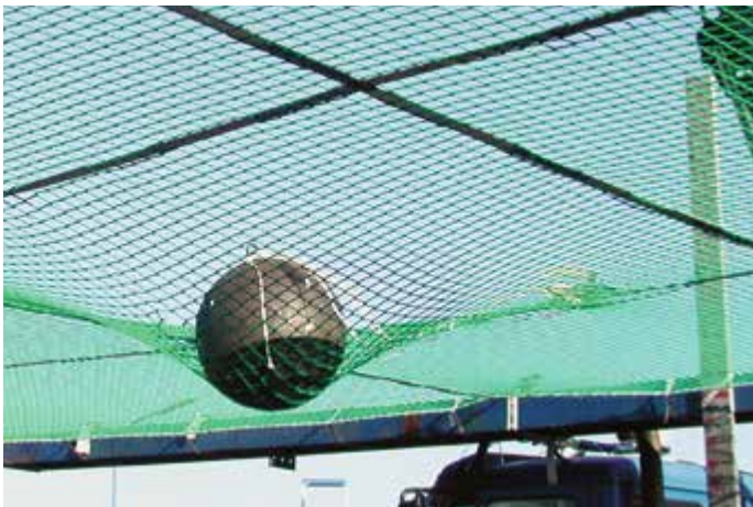
Test: Die 100 kg schwere Eisenkugel wurde aus 3 m Höhe in das Netz fallengelassen.
