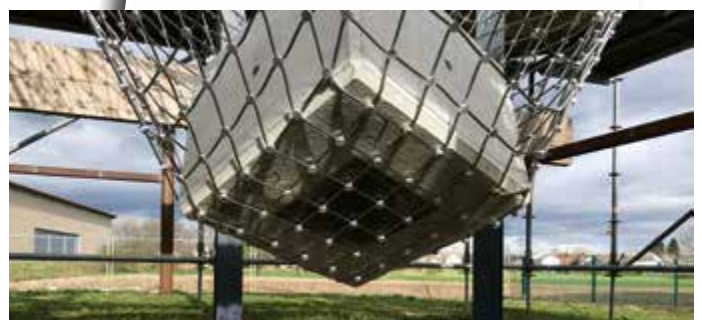
Ist-Zustand nach dem Fallversuch, mit ausgelösten „Dämpfern“
