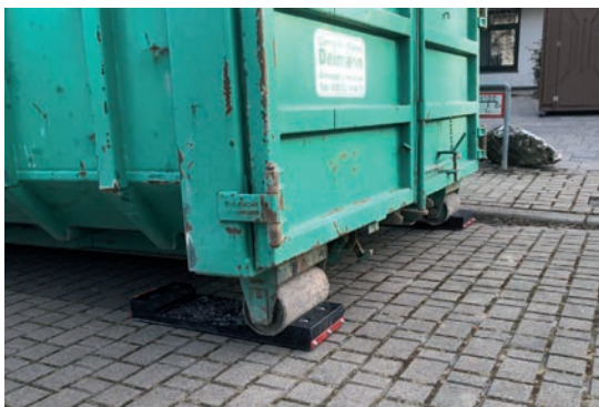
Untergrundschutzplatten im Einsatz
