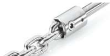
Kettenadapter M12 aus Edelstahl Art.-Nr. 461-6 inkl. Gewindeanschluss f r Gewindebolzen, zur Verbindung mit Kette 6 mm
