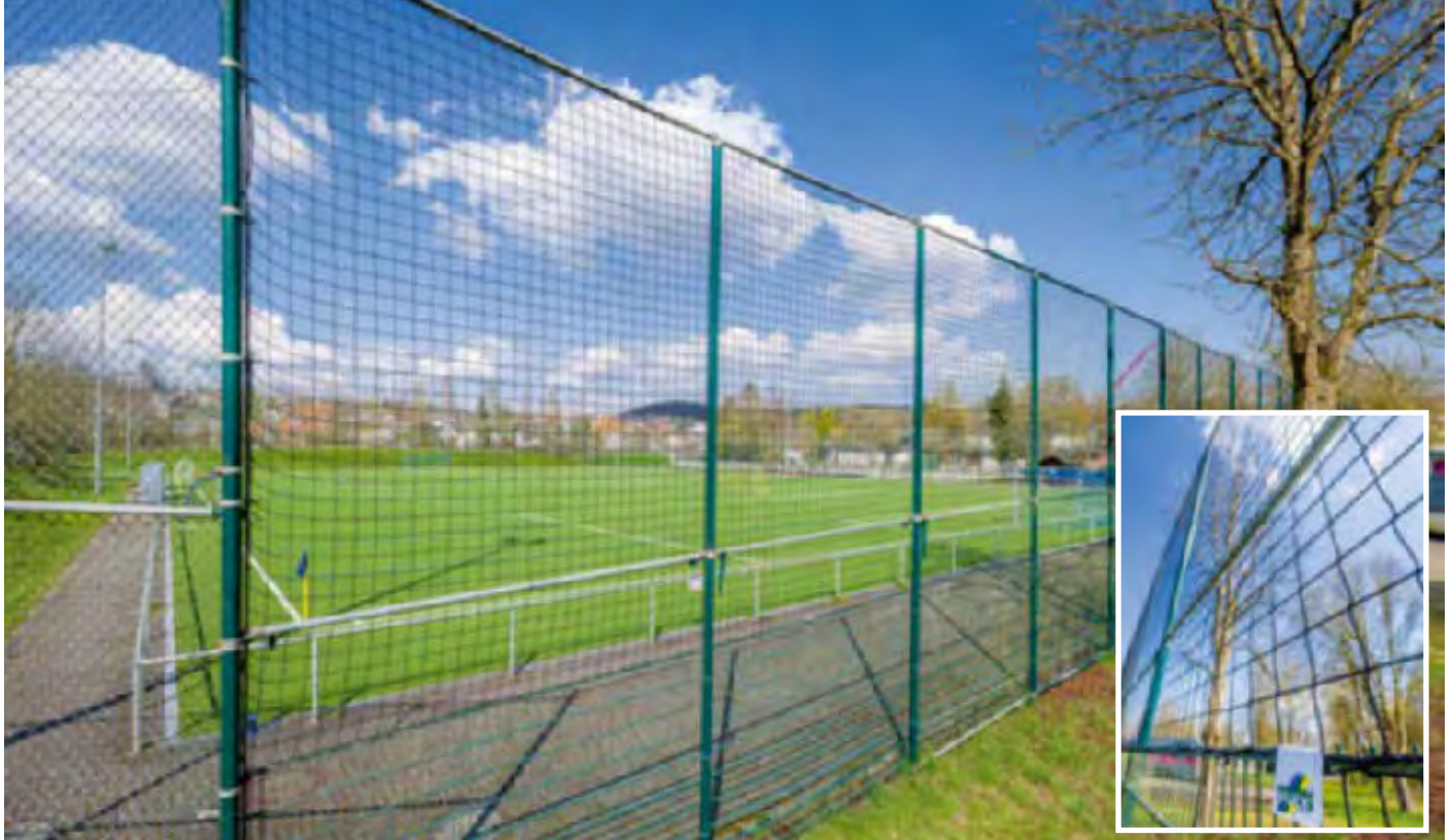
Ballfangnetz „Ultra“ aus PE, ca. 4,5 mm stark in Flecht/Flecht-Technik mit hoher Abriebfestigkeit und hoher Schnittwiderstand dank starkem Materialdurchmesser.
