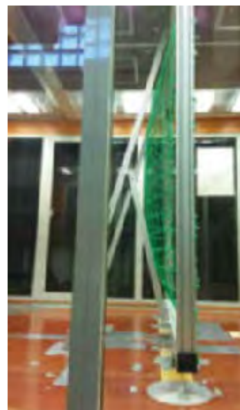
Versuchsaufbau zur Messung der Windlast
