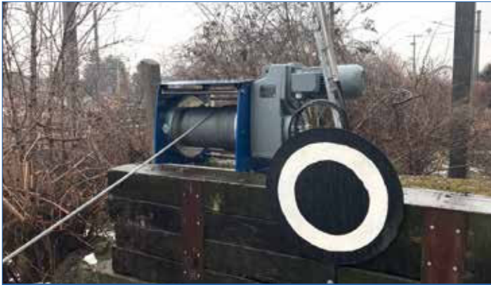
PFW-E 1000 als Zugwinde für Eisenbahnwagen
