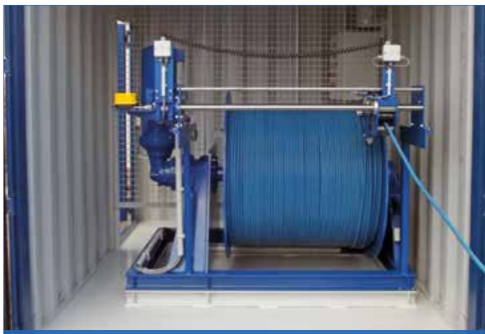
SB-E 306 als Sondierungswinde mit 1.800 m Datenleitung
