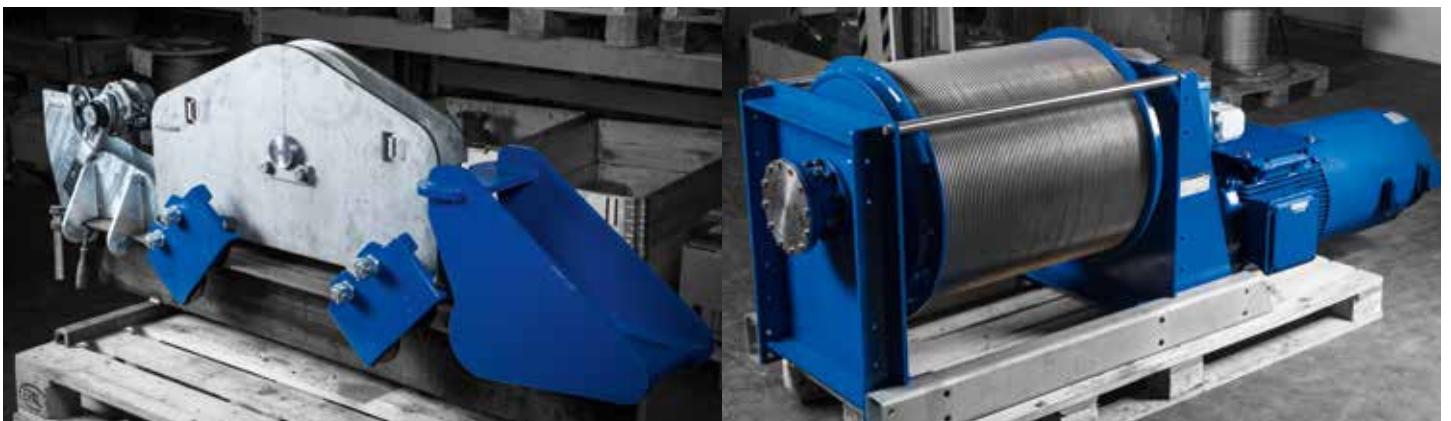
SK-E 07 als Traversierwinde und Umlenkrollenbock für einen Lebensdauerprüfstand von Kabelzuführungen an Hafenkranen
