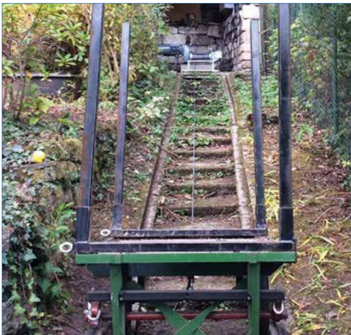
PFW-E 2000 als Hubwinde für Rotorblattprüfungen
