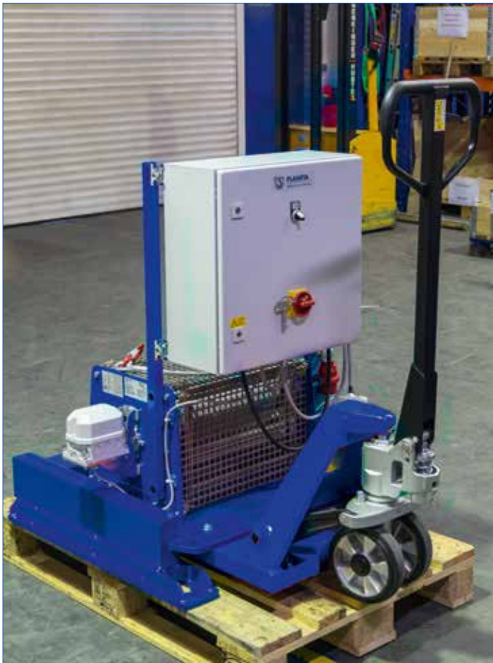
PFW-E 3000 als mobile Zugwinde für Bahninstandsetzung
