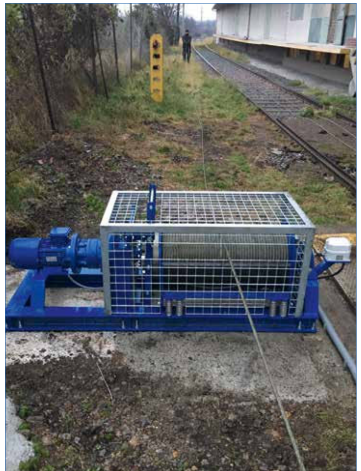
SB-E 305 als Traversierwinde an Waggonbefüllstation
