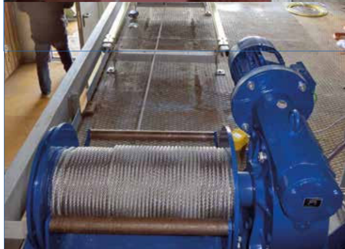
MC-E 2200 als Hubwinde für Spurfräse an Skisprungschanzen
