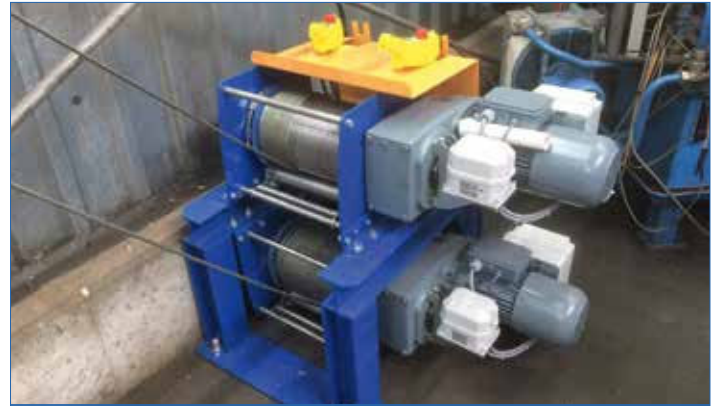
PFW-E 1000 als Doppelwindenbock für einen Prüfstand
